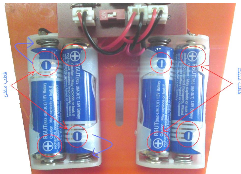
تصویر شماره ۱۴ : نحوه قرار دادن باطری‌ها در جاباطری‌ها (قطب منفی هر باطری سمت فنر جاباطری)
